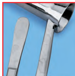
Следствие: инструменты со следами извести
