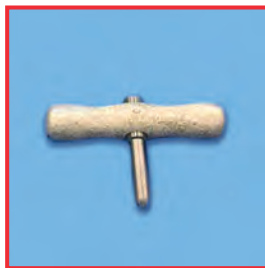
Травление паяных швов. У твердосплавных ножниц, пинцетов и иглодержателей Причина: кислотная коррозия из-за передозировки химии нейтрализации или использования основного очистительного средства.
