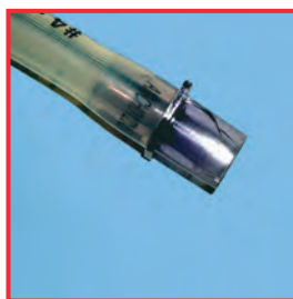
Трещина вследствие напряжений
