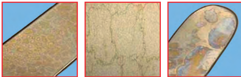
Типичное окрашивание поверхности инструментов силикатами после паровой стерилизации из-за повышенного содержания кремниевой кислоты в деминерализованной воде.
