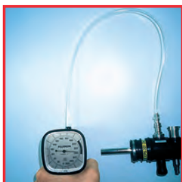
Ручная проверка герметичности гибкого эндоскопа
