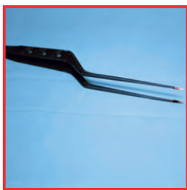
Деформация вследствие неправильного обращения
