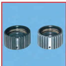
Изображение справа: повреждение материала умягченной водой.
