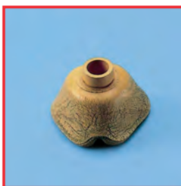
Трещины старения на респираторной маске
