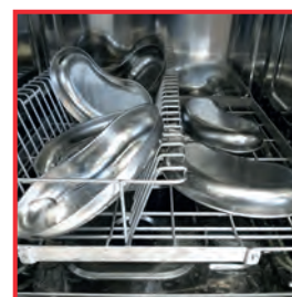
Неправильная загрузка/опрокинутые почкообразные лотки
