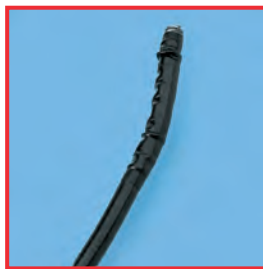
Разбухание подающего шланга вследствие использования неподходящего средства для ухода.
