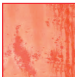
Воздействие на материал натуральной/анодированной алюминиевой поверхности контейнеров. Причина: моющий раствор с недопустимо высоким содержанием щелочи
