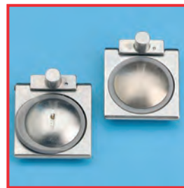
Справа: негерметичный откидной клапан троакара вследствие разбухания уплотнения из-за контакта с маслом. Слева: новый откидной клапан
