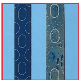
Видимые изменения анодированного алюминия уже при незначительном содержании щелочи
