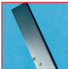
Пример язвенной коррозии
