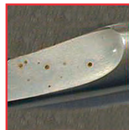
Пример язвенной коррозии
