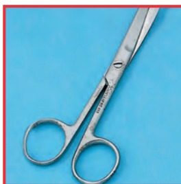
Ножницы с язвенной коррозией
