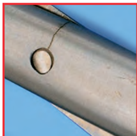
Трещины вследствие напряжений в зоне шарнира ножниц
