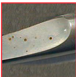
Язвенная коррозия инструмента под действием хлоридов.
