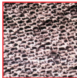
Травление паяных швов. У твердосплавных ножниц, пинцетов и иглодержателей Причина: кислотная коррозия из-за передозировки химии нейтрализации или использования основного очистительного средства.
