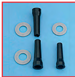
Справа: разбухшее уплотнение вследствие неточного нанесения инструментального масла. Слева: новые уплотнения
